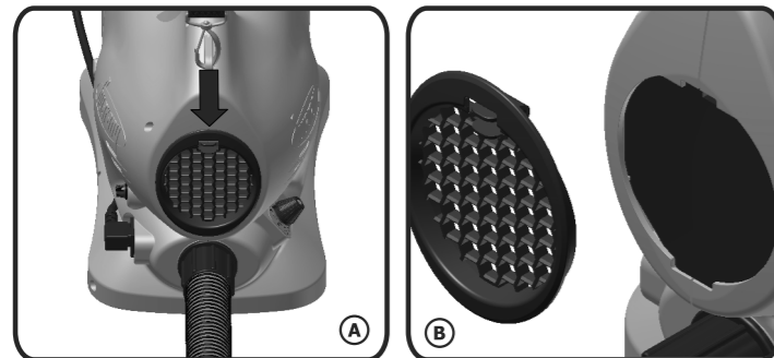
Figura 9 Procedimiento de retirada del filtro de aire para mantenimiento.
